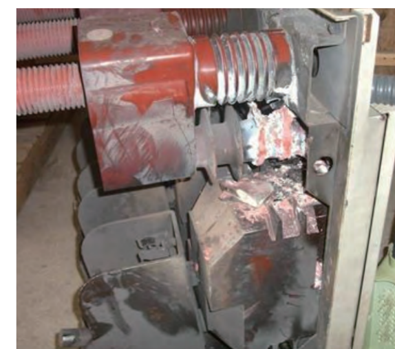
弧光接地过电压导致PT爆炸
